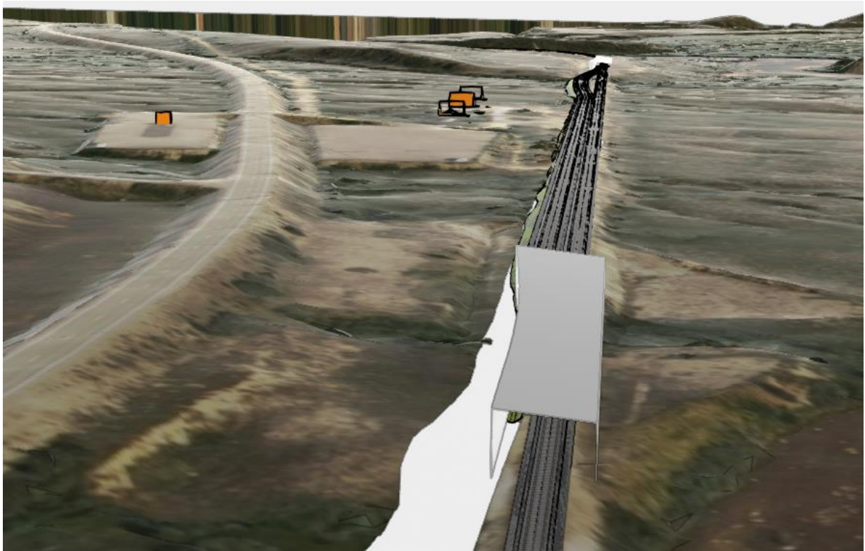
Figur 5-8 Alternativ 3 Semska nord. Utklipp fra modell sett fra sør mot nord. Snøoverbygg av stål i begge ender.
