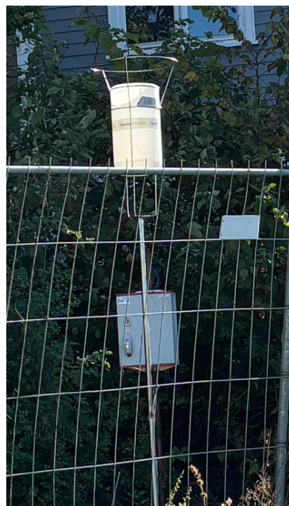
Figur 9. Stasjon for måling av støvnedfall like ved anleggs-gjerdet. Foto: Bane NOR.
