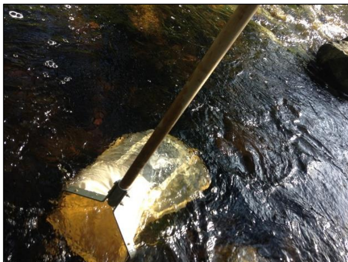
Figur 2-1. Sparkehov benyttet til innsamling av bunndyrprøver. Foto: COWI.
