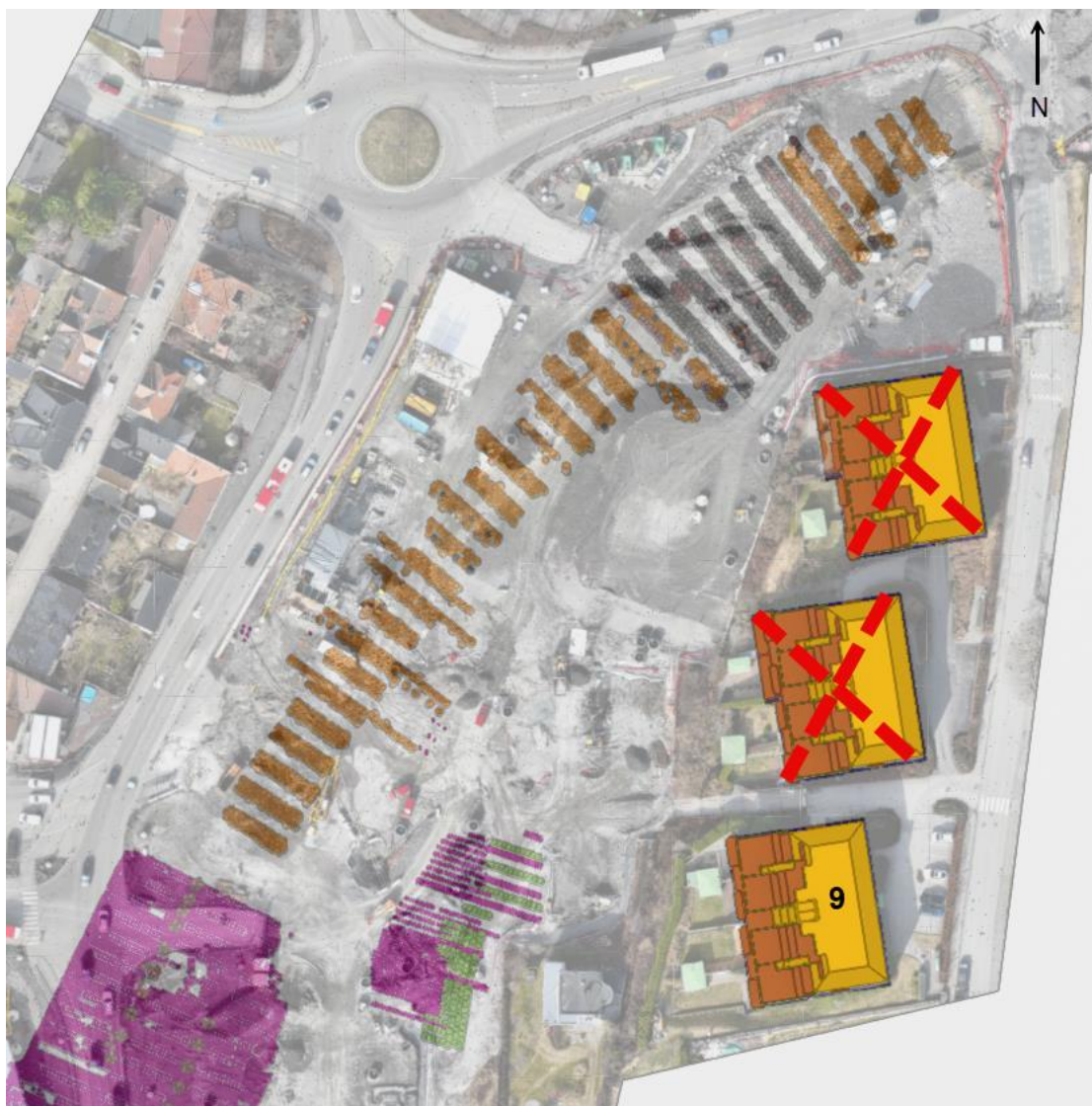
Figur 1-1. Planoversikt for Høienhaldgata 9 med etablert grunnforsterkning. Høienhaldgate 5 og 7 skal rives i løpet av høsten 2025.
