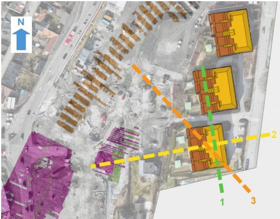
Figur 3-2. Beregningssnitt for stabilitetsberegninger Høyenhaldgata 9.
